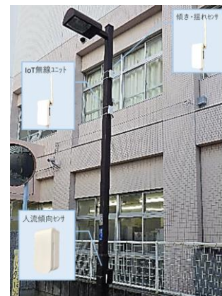
阿佐ヶ谷中学校に設置したIoT街路灯の実証実験(平成30(2018)年1月)
