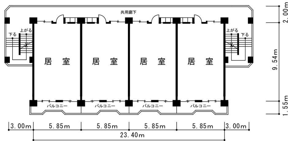
2号棟 2階・3階平面図 S = 1 / 200
