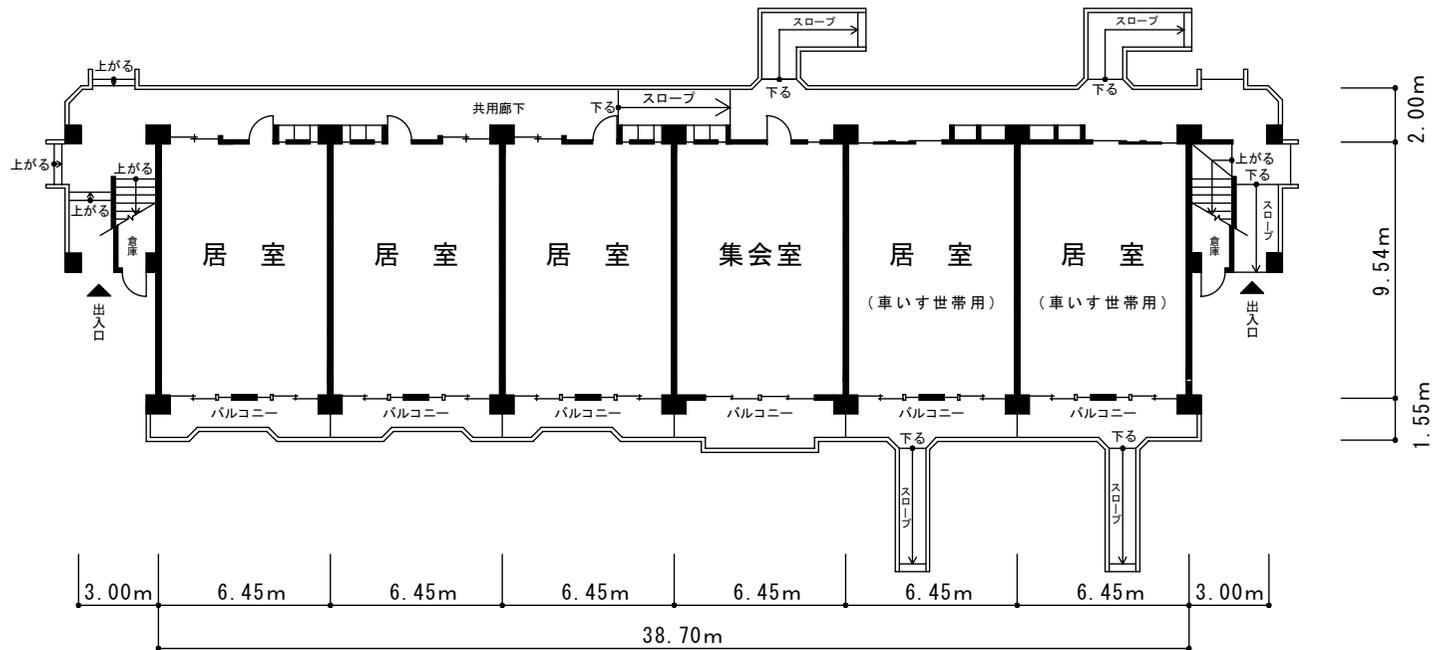
1号棟 1階平面図 S = 1 / 200
