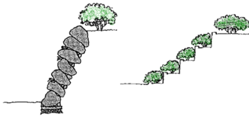
擁壁の作り方の工夫
