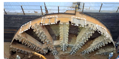
外周リング保護ビット 【外周リングを保護する部材】
