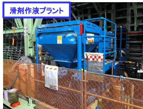
滑剤充填設備(大泉本線(北行)シールドトンネル工事の実績)
