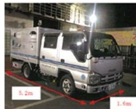
路面下空洞探査車
