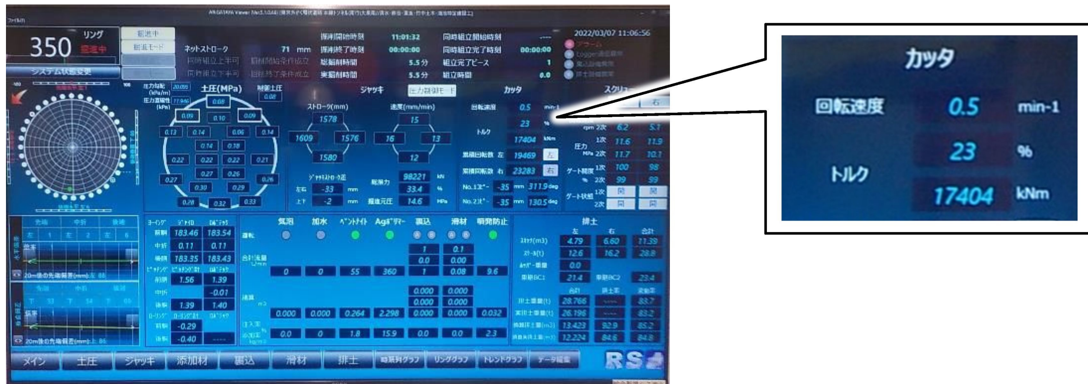
カッタートルクのリアルタイム監視状況 (350R)
