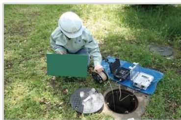
地下水位の観測状況
