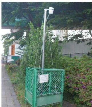
大気質(粉じん等)測定状況
