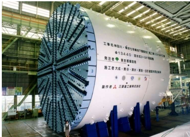
シールドマシン：環状七号線地下調節池
