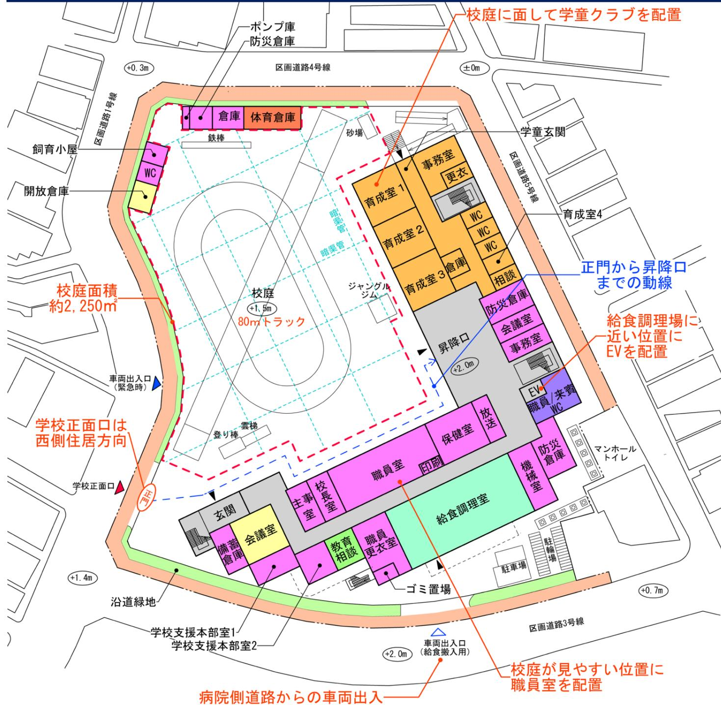
1階平面図兼配置図
