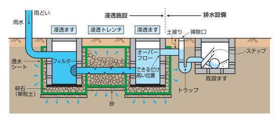
浸透ますや、浸透トレンチを砕石で覆います。雨どいとつなぎ、雨水が流れ込むと砕石の中に水がたまり、自然に土に浸み込んでいきます。
