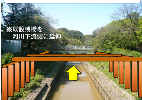
写真⑤：河川上栈橋（設置工事中のイメージ）
