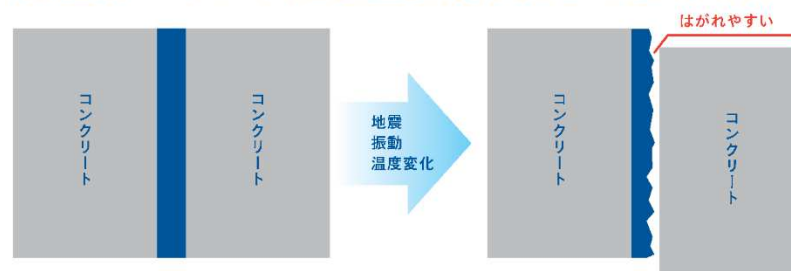
図 1-4.6 STTG 工法と従来工法の長期耐久性の観点での比較 STTG 工法パンフレット ( https://www.sttg.or.jp/introduction/ )
