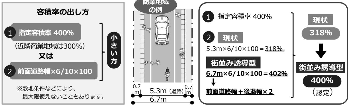
容積率は①指定容積率と②前面道路の幅で計算された数値を比較して、**小さい方**が利用できる容積率となります。街並み誘導型地区計画を導入し、0.7m(70cm)後退して歩行者空間を計画すると、前面道路の計算はこの0.7m(70cm)の2倍を加えた幅員で計算できます。
