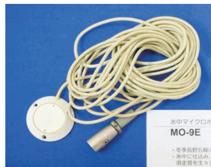
スケートリンクの氷中に埋め込み、スケートの刃が氷を滑る音を拾うマイク。
