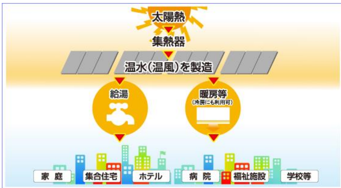
図3 太陽熱利用設備 概略図
