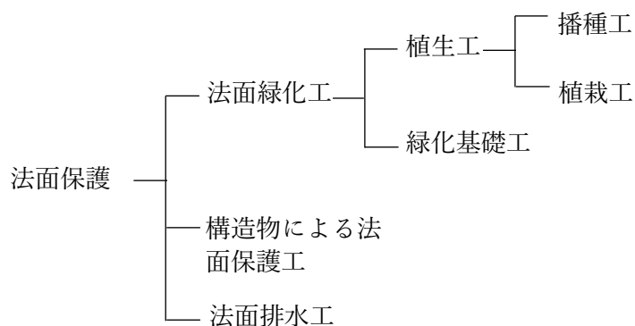
図 3-54 法面保護工の分類
