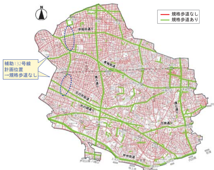
▲杉並区内の規格歩道の設置状況
