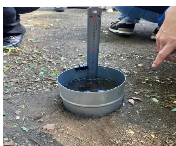
【雨水浸透実験の様子】
