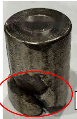
ラジアルベアリングの損傷状況
