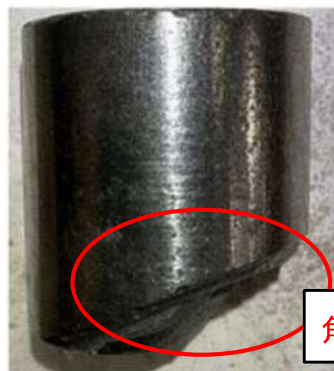
スラストベアリングの損傷状況
