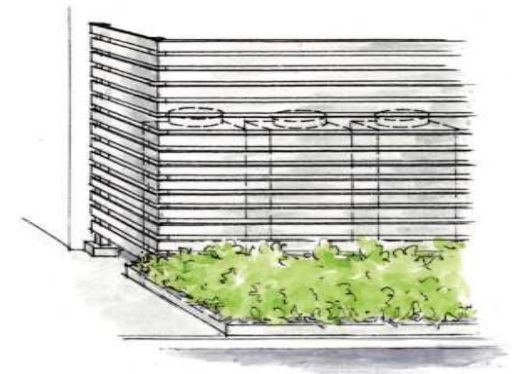
道路側に設置する室外機
