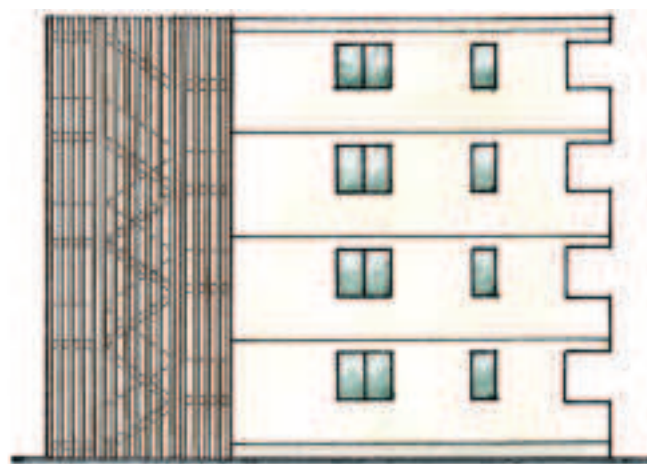
屋外階段に目隠しを設置
