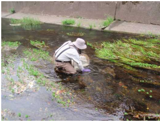
D フレームネットによる底生動物の定量採集
