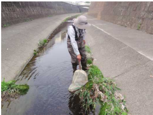
タモ網による底生動物の定性採集
