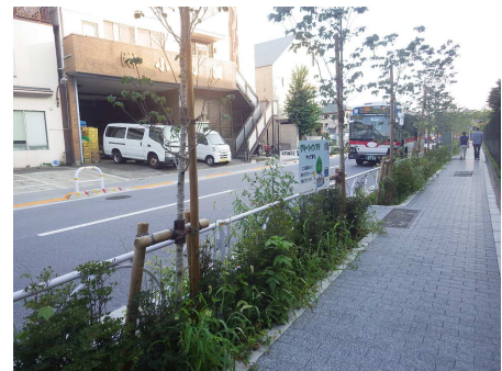
▲雨水を浸透させる植栽帯（道路）
