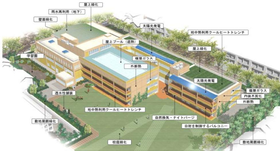
平成 21 年 3 月に竣工(移転改築)した荻窪小学校では、これまで進めてきた校舎屋上・壁面の緑化や校庭の芝生化、通風・換気による排熱などの取組みをさらに一歩進め、外断熱や複層ガラス、地中熱を利用した換気システム(クールヒートトレンチ)を採用入れるなど、「まるごとエコスクール」としています。
