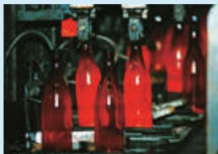
破碎したびんを溶かした後、びんの形に再形成します
