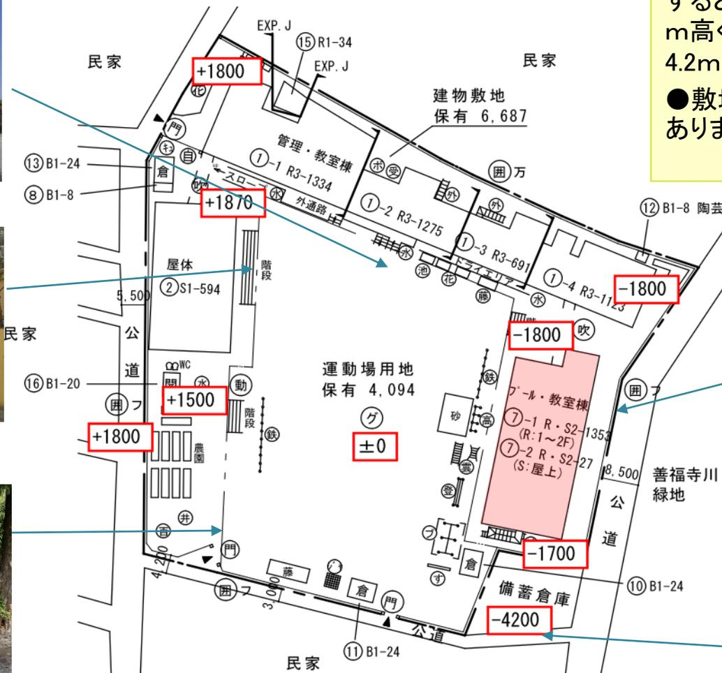
●運動場を基準(±0)とすると、西側道路が約1.8 m高く、東側道路は、約4.2m低くなっています。
