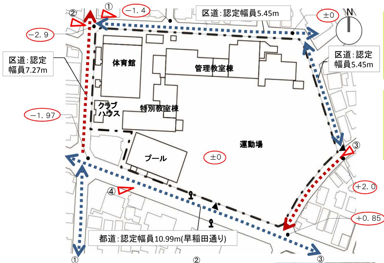
●運動場を基準(±0)とすると、西側道路が約3.0m低く、東側道路は、約2.0m高くなっています。
