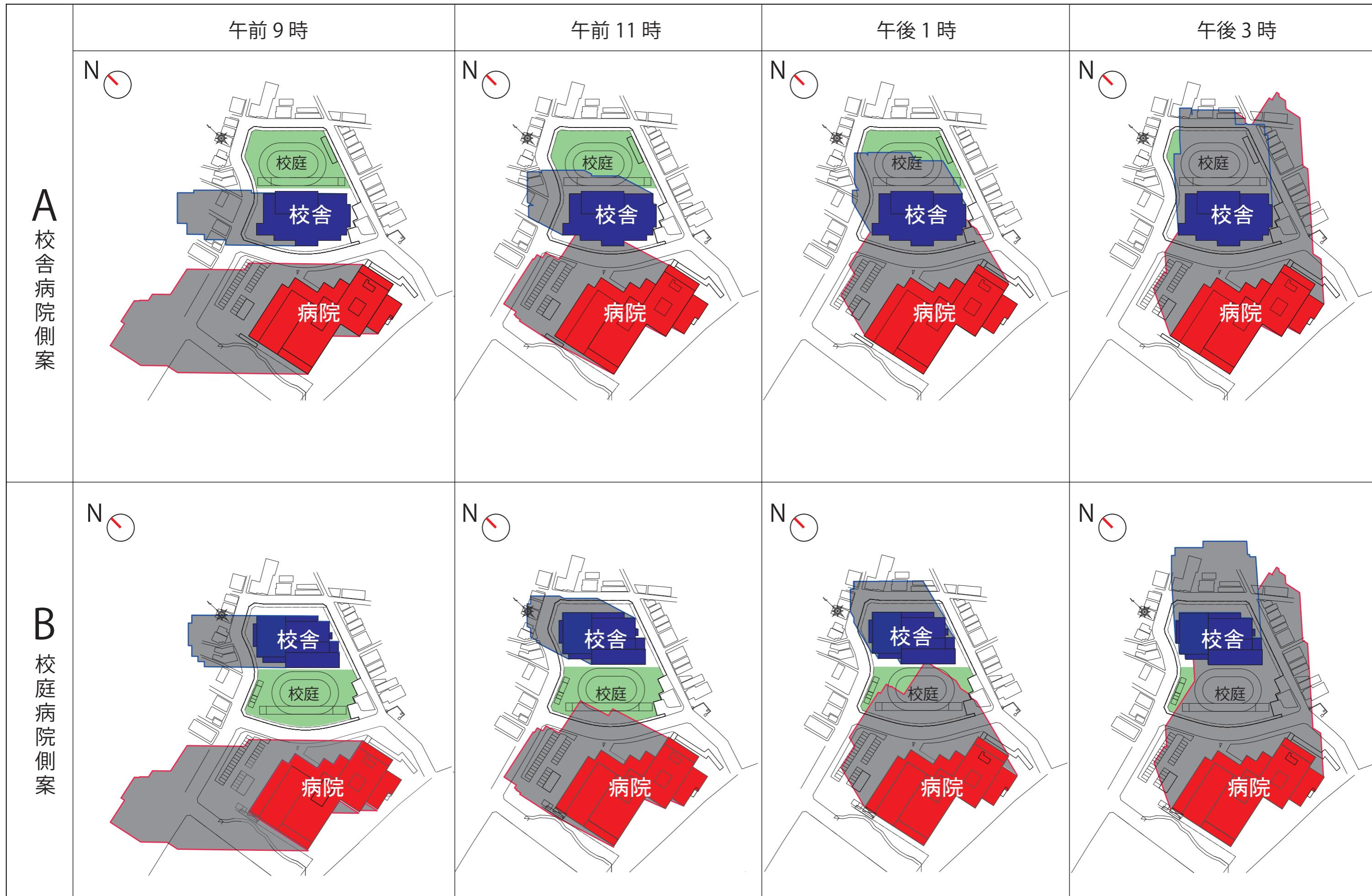
一般的な時刻日影 8 時～16 時の内、小学校の授業時間帯の代表的な日影を試算し、地盤面は小学校の1FLをGL±0と設定して検討しています。
